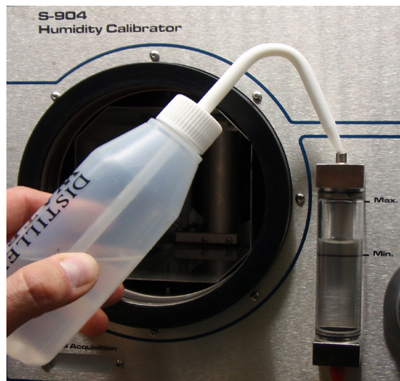
Abb. 9 Auffüllen des Wasserbehälters
