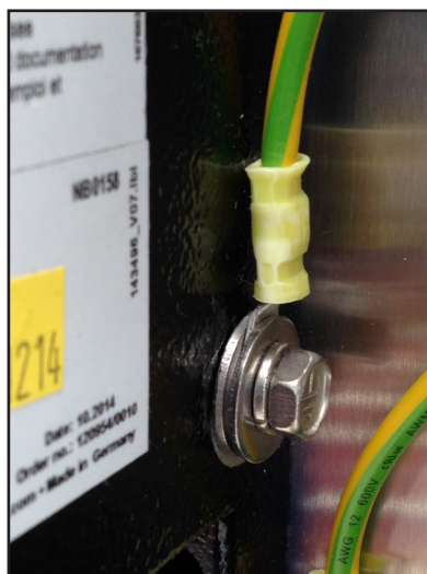
Schéma 3 Assemblage goujon de mise à la terre, écrou et rondelle
