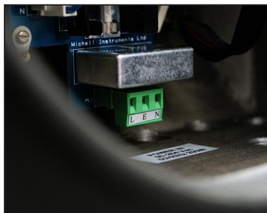
**Рис. 2** Разъем для подключения питания
