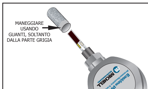
Figura 11 Sostituzione della protezione del sensore
