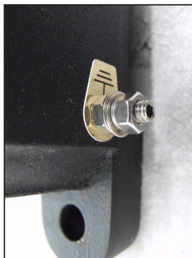
Figura 2 Borchia di messa a terra con bullone e rondella
