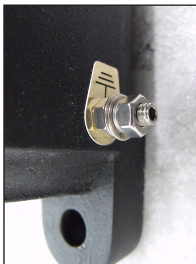
Schéma 2 Plot de mise à la terre et montage écrou et rondelle
