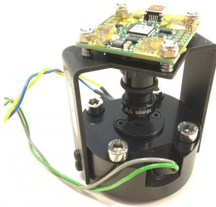
**Рисунок 41** Блок камеры в сборе
