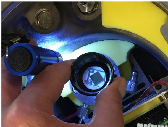
**Рисунок 40** Проверка поверхности зеркала
