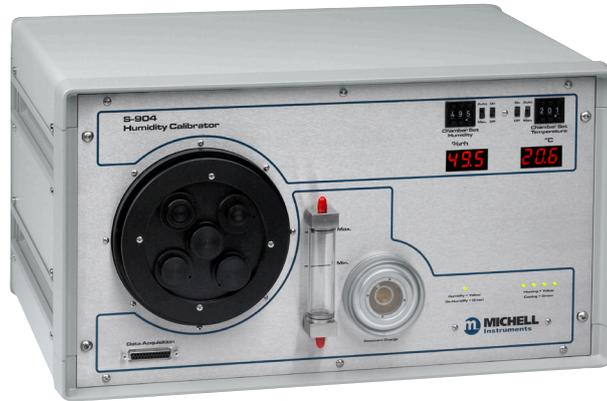
O S904 é um calibrador completamente autônomo e transportável para sensores de umidade, sem necessidade de serviços externos que não seja a fonte de alimentação. A câmara de calibração possui 5 portas intercambiáveis para acomodar praticamente qualquer marca, tipo ou modelo de sensor. Este calibrador é ideal para empresas ou organizações que procuram calibrar um grande número de sondas em um ambiente de laboratório ou em campo.
